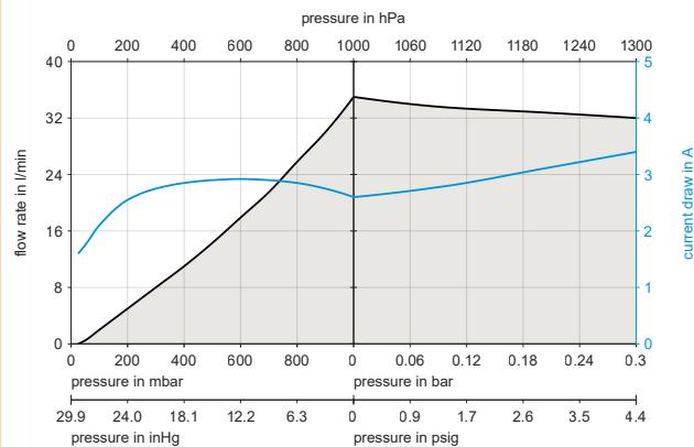
Förderrate ermittelt bei 20°C, 1000 hPa mit Luft
