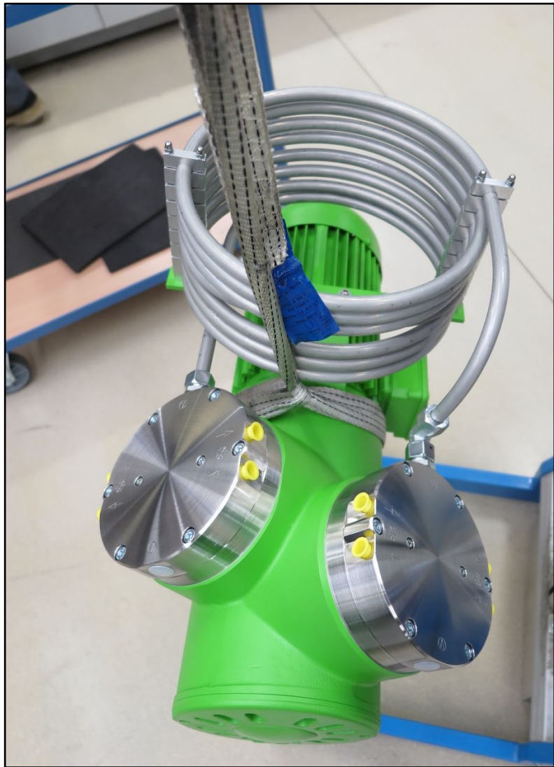
Abb. 4: Position des Tragegurts (beispielhaft)
