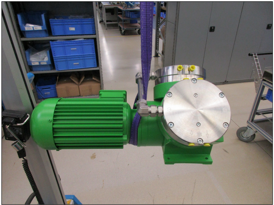
Abb.6 Befestigung des Tragegurts (Pumpe beispielhaft dargestellt)
