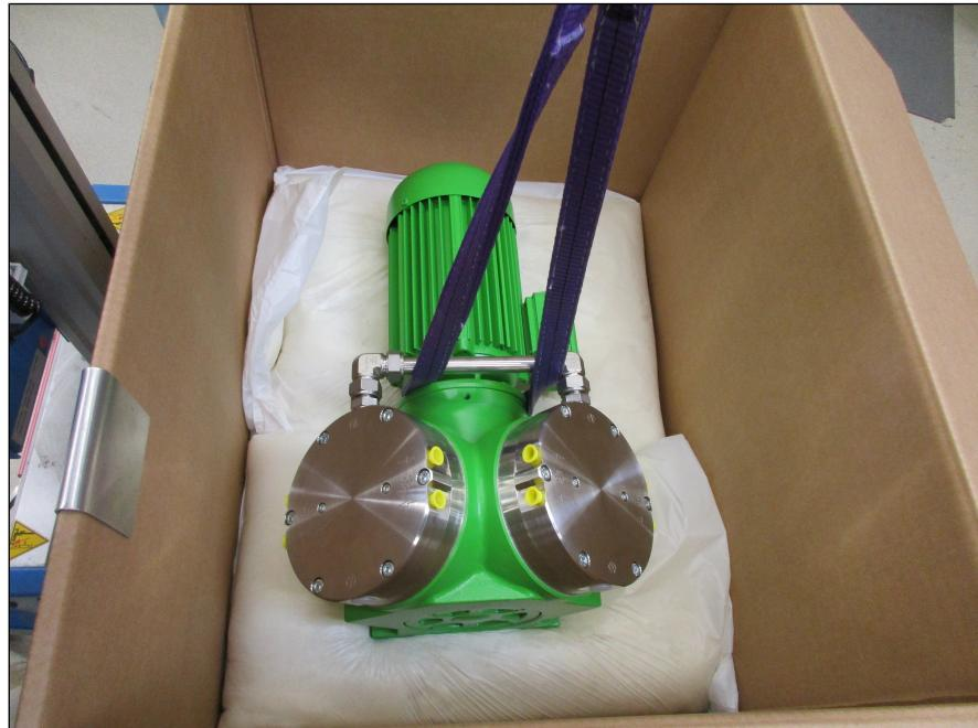
Abb.6 Position Tragegurt (beispielhaft)
