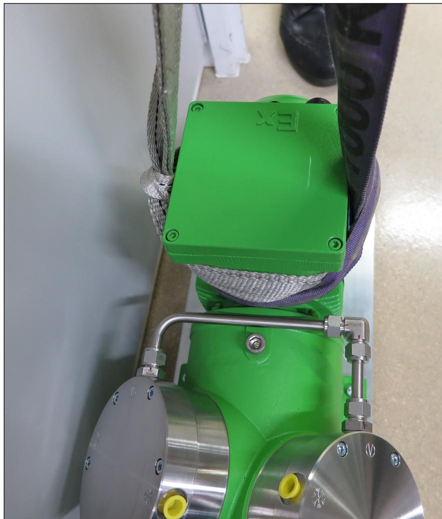
Abb.20 Motor anheben (dargestellte Pumpe beispielhaft)
